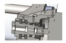
射胶传动轴采用三轴承设计,保证同轴度,螺 杆料筒磨损小;
